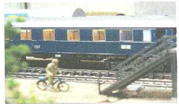
Indirekte Beleuchtung (gleichmäßige Ausleuchtung) die LEDs wirken nach oben.
